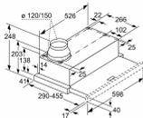
La adaptación de la profundidad de la coquera del filtro es posible hasta 20 mm. Dimensiones en mm
